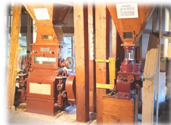
Komplett restaurierter Walzenstuhl und Grießauflöser
